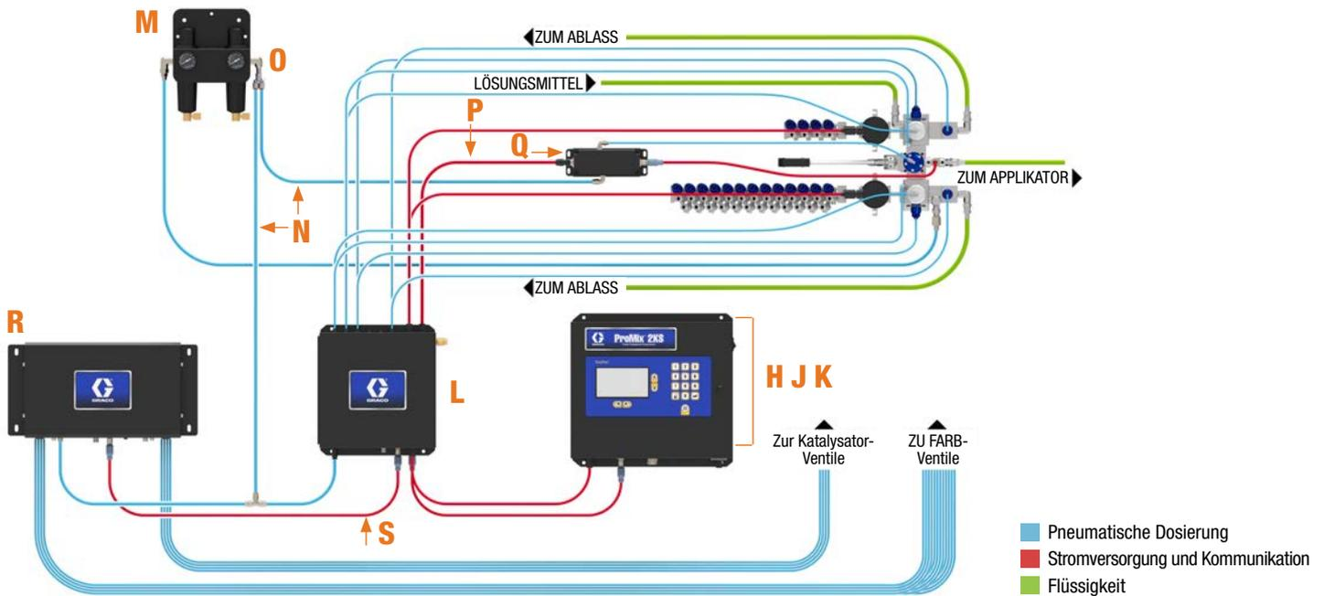
**4** Bestellen Sie das Farbwechsel-Steuermodul, das für die Verwaltung des Farb- und Härterwechselprozesses erforderlich ist, genau wie bei einem 2KS-System. Auswahlmöglichkeiten sind im Handbuch **312787** dargestellt. **(Pos. R)**
